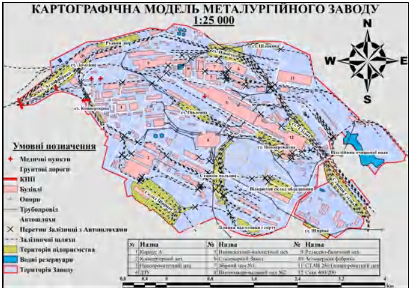
Рисунок 3.2 – Картографічна модель металургійного заводу
