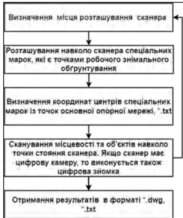
Рисунок 2.8 – Етапи наземного лазерного сканування
