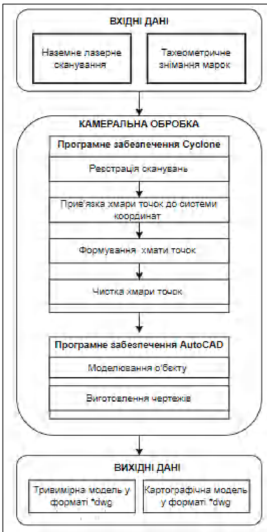
Рисунок 3.7 – Структурна схема обробки даних наземного лазерного сканування
