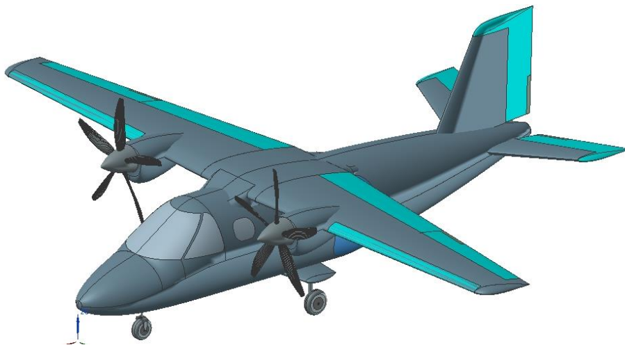
Рисунок 4 – Фрагмент загальної майстер-геометрії ХАІ-90
