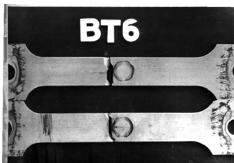
Рис. 4. Характер усталостного разрушения гладкой полосы из сплава ВТ6 в условиях фреттинг-коррозии
