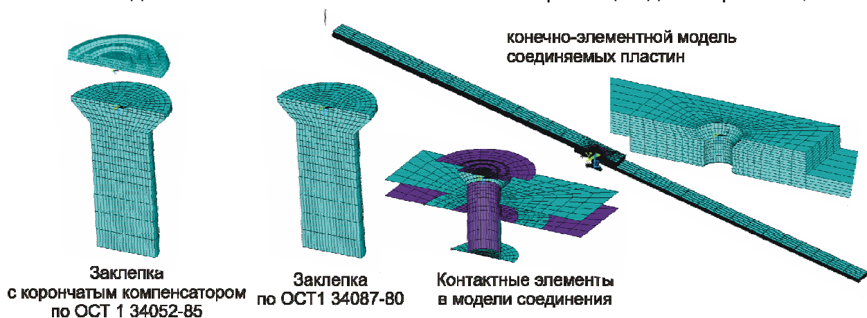
Рис. 7. Конечно-элементная модель однорядного заклепочного соединения
