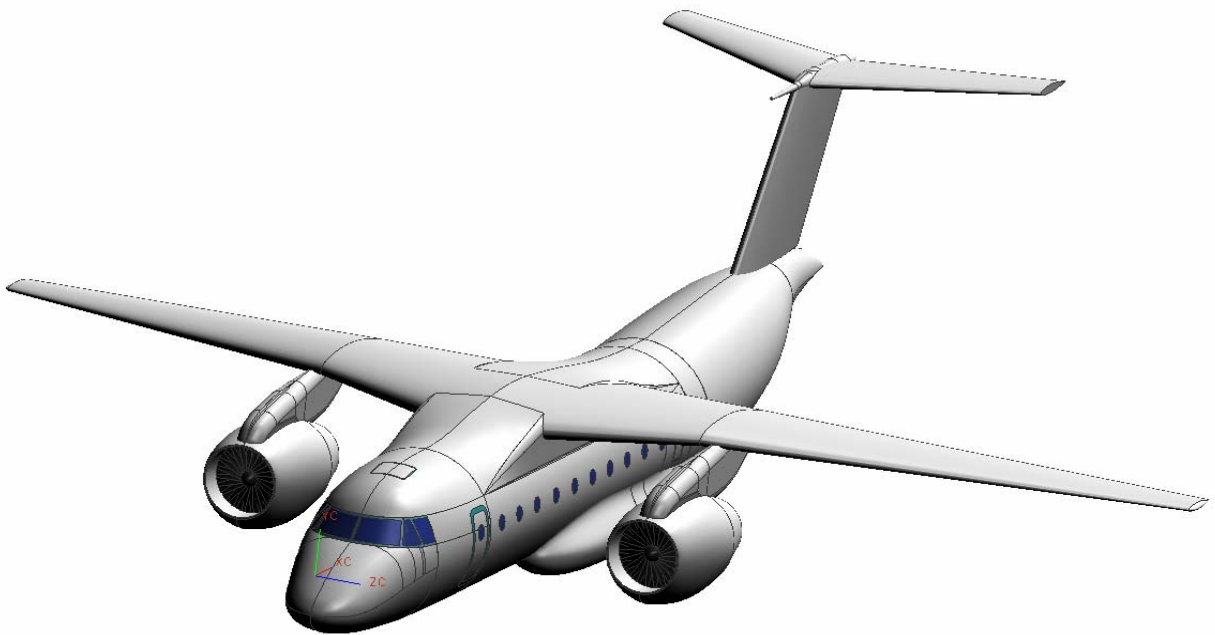
Рис. 12. Мастер-геометрия поверхности фюзеляжа гражданского самолета, созданная с помощью компьютерной интегрированной системы CAD/CAM/CAE Unigraphics
