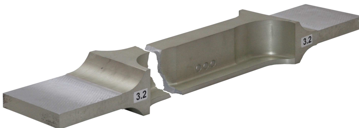
Рис. 9. Характер усталостного разрушения конструктивно-подобного образца стрингера (материал Д16Т), обработанного в зоне отверстий последовательным применением дорнования и барьерного обжатия на уровне нагружения
