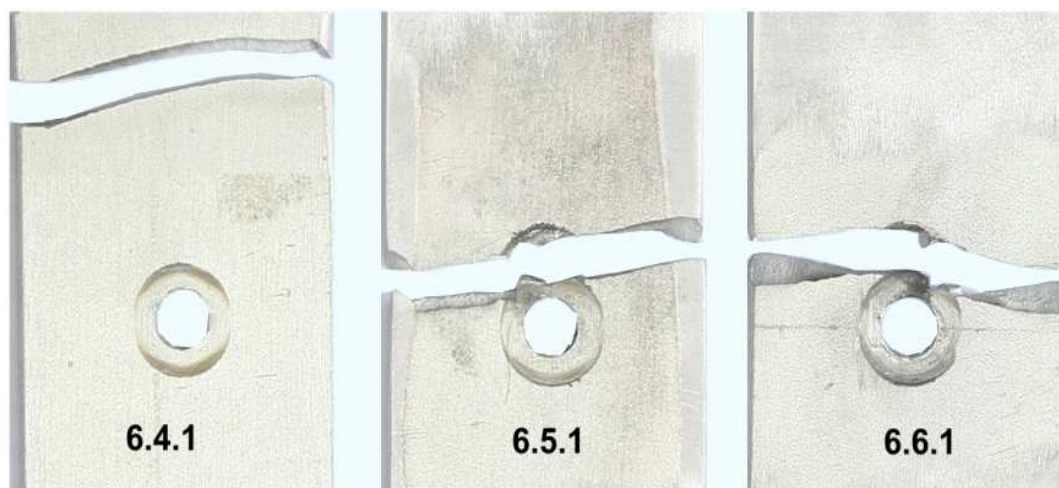
Рис. 16. Характер усталостного разрушения конструктивно-подобных образцов полос из материала Д16АТ л.5 с отверстием, заполненным болтом 8-34-Ан. Окс-ОСТ 1 31066-86 с радиальным и осевым натягами при экспериментальных исследованиях в условиях фреттинг-коррозии в контактной паре со шлифованными шайбами с нанесенным на них покрытием \{Cr+(TiCr)N\} \times 10 при уровне напряжений \sigma_{бр\ min} = 0 МПа, \sigma_{бр\ max} = 150 МПа
