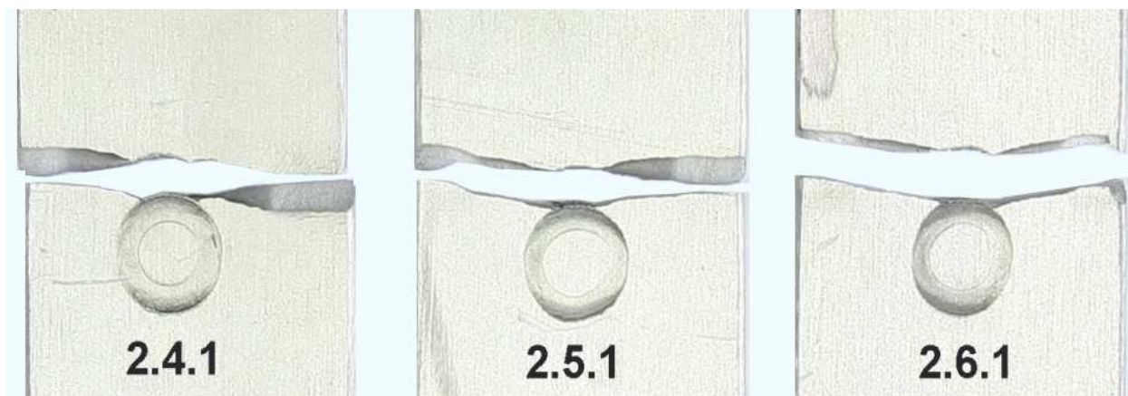
Рис. 12. Характер усталостного разрушения конструктивно-подобных образцов гладких полос из материала Д16АТ л.5 при экспериментальных исследованиях в условиях фреттинг-коррозии в контактной паре с прижатыми шайбами с нанесенным на них покрытием {Cr+(TiCr)N} x10 при уровне напряжений
