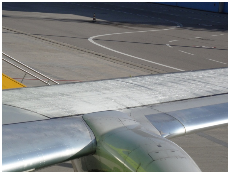
Рисунок 2.7 – «Паливний лід» на крилі
