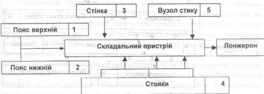
Рис. 2.4. Схема складання лонжерона
