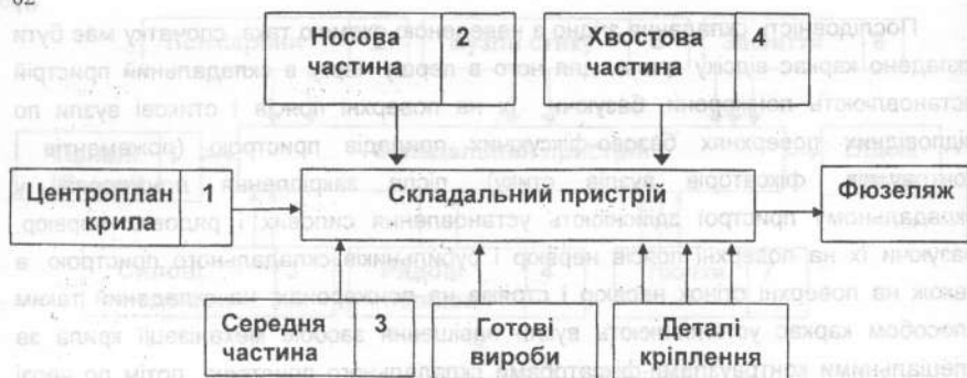
Рис. 2.7. Схема складання фюзеляжу з готових відсіків
