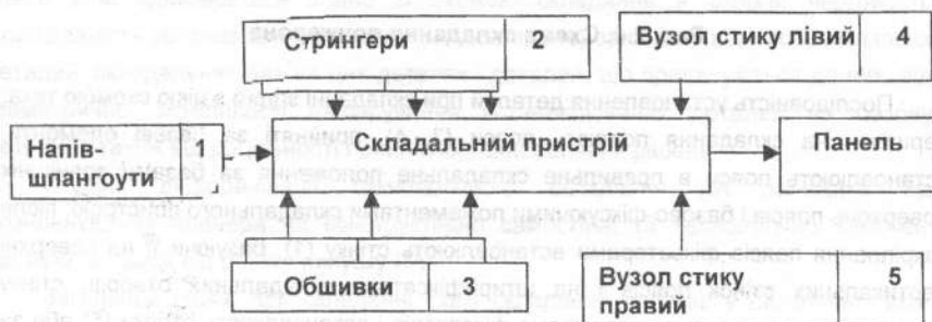
Рис. 2.5. Схеми складання панелі
