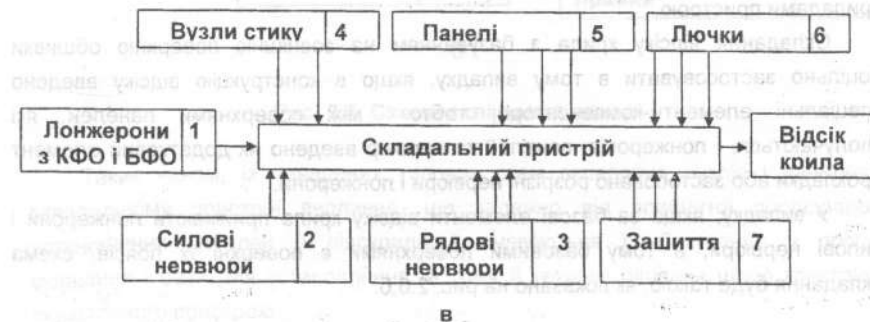
Рис. 2.6. Схеми складання відсіку крила
