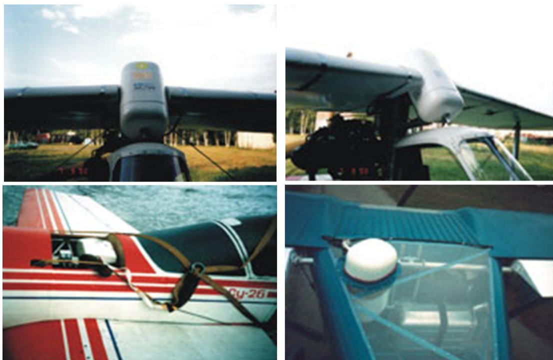
Рисунок 3.6 - Приклади встановлення БПС
