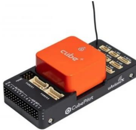
Рисунок 1.6 – Політний контролер HEX Pixhawk 2.1 Cube Orange+
