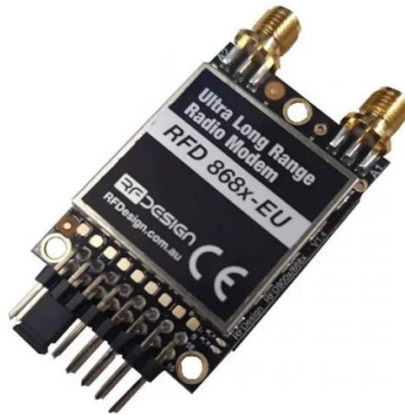
Рисунок 1.7 – Радіомодем телеметрії RFDesign RFD868x
