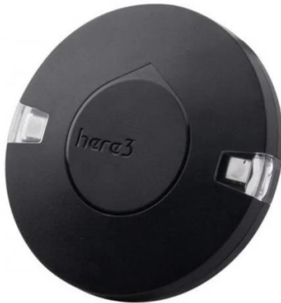
Рисунок 1.8 – Приймач GPS HEX Here 3+
