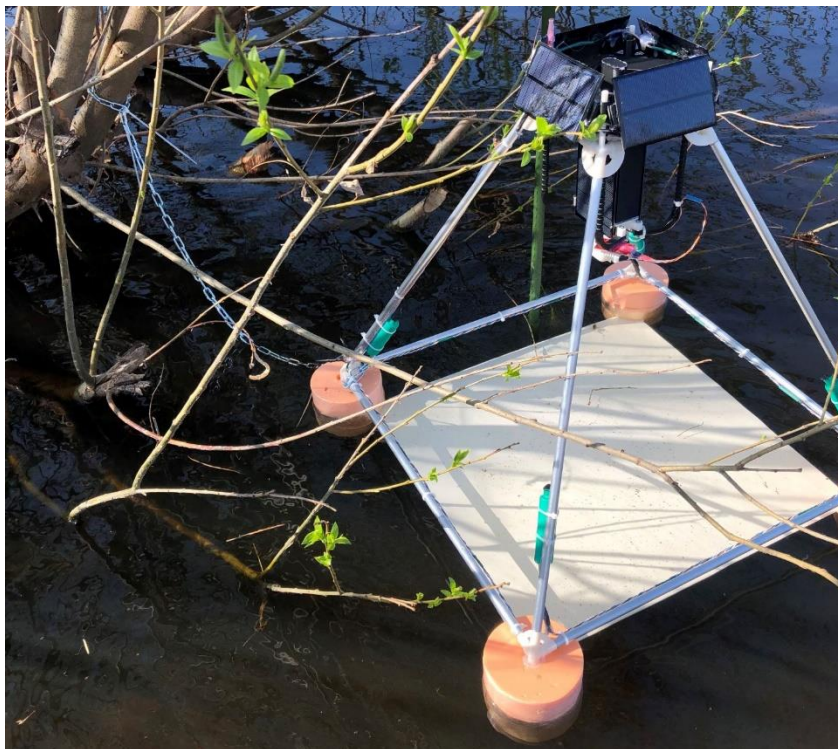
Рисунок 1.8 – Автономна система моніторингу розвитку малярійних комарів
