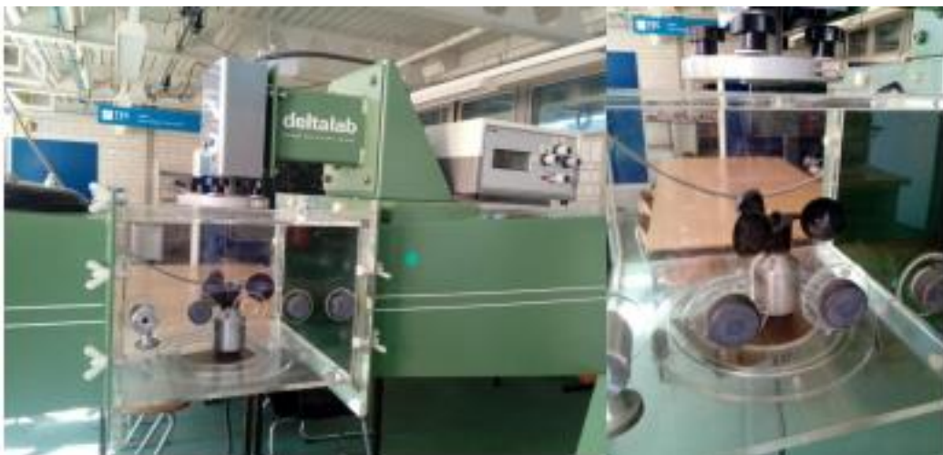
Рисунок 5.2.1 – Анемометр усередині вітрового каналу
