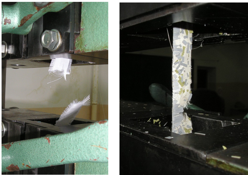
Рисунок 6 – Разрушившиеся образцы полотна (а) и обшивки (б) в испытательной машине
