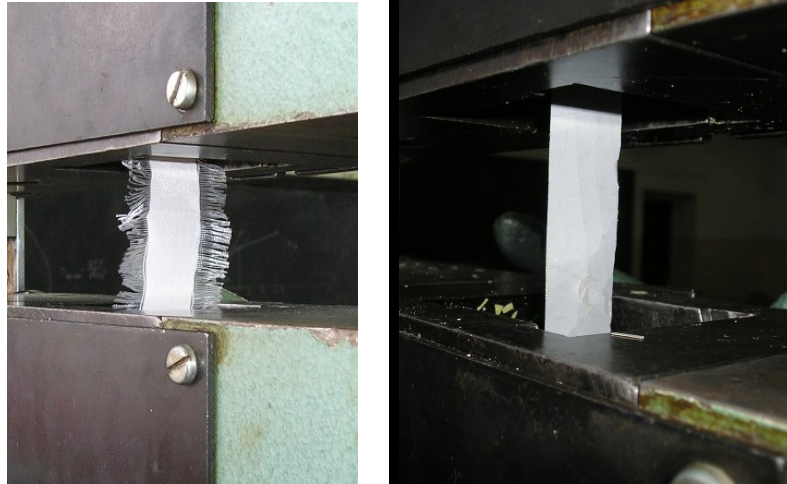
Рисунок 5 – Образцы полотна (а) и обшивки (б), установленные в зажимах испытательной машины
