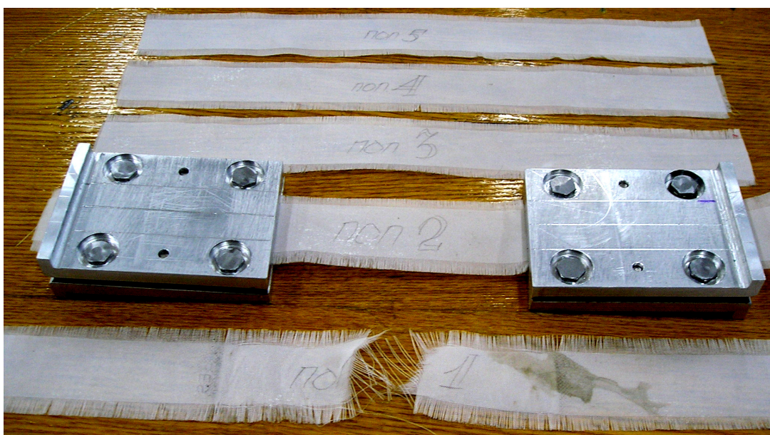
Рисунок 2 – Общий вид образцов (растрепанная лента), образец, подготовленный к испытанию (“в щечках”) и после разрыва
