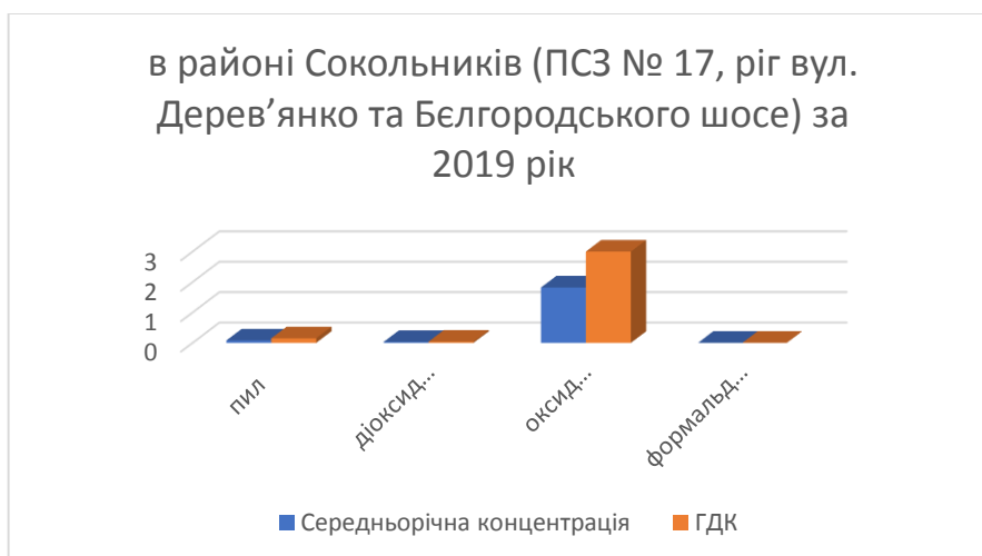
Рисунок 4.16 – Середньорічна концентрація шкідливих речовин в порівнянні з ГДК в районі Сокольників за 2019 рік
