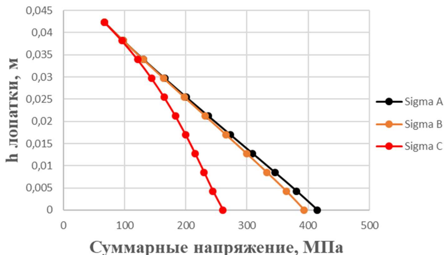
Рисунок 2.10 – Зміни сумарних напружень за довжиною пера лопатки
