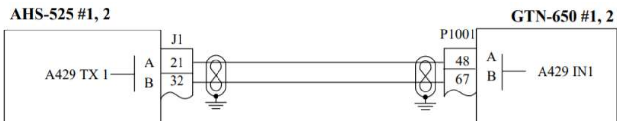
Рисунок 3.5 – Схема з'єднань «GTN 650 – AHS525»
