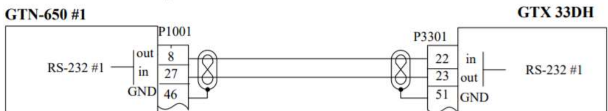
Рисунок 3.8 – Схема з'єднань «GTN 650 – GTX33DH»
