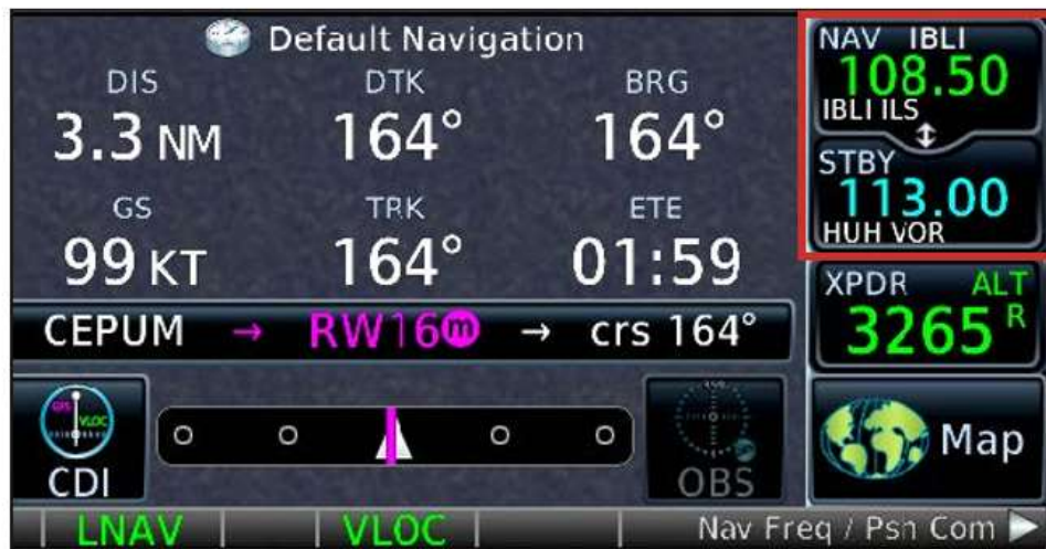
Рисунок 5.12 – Екранна форма система ближньої навігації GTN 650
