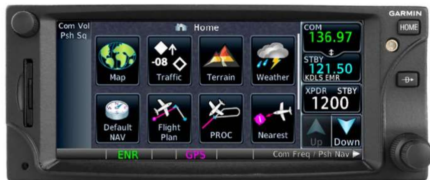
Рисунок 5.1 – Система ближньої навігації GTN 650, встановлена на борту Мі–8МСБ
