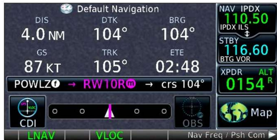
Рисунок 5.10 – Екранна форма система ближньої навігації GTN 650
