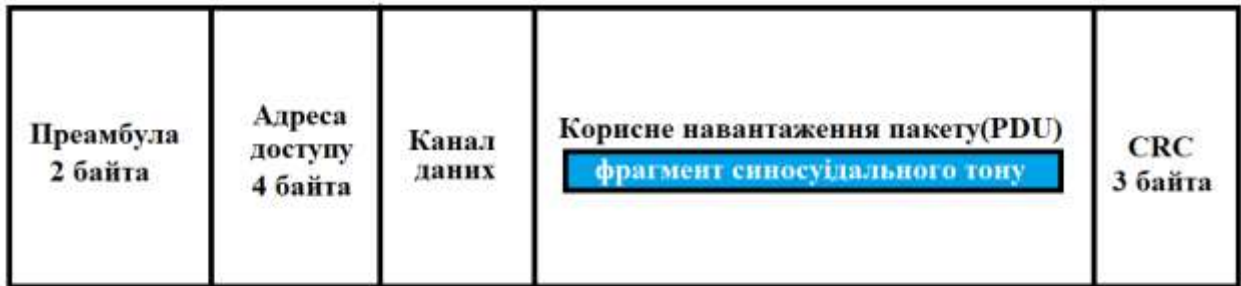
Рисунок 2.18 – Структура пакета для визначення напрямку джерела
