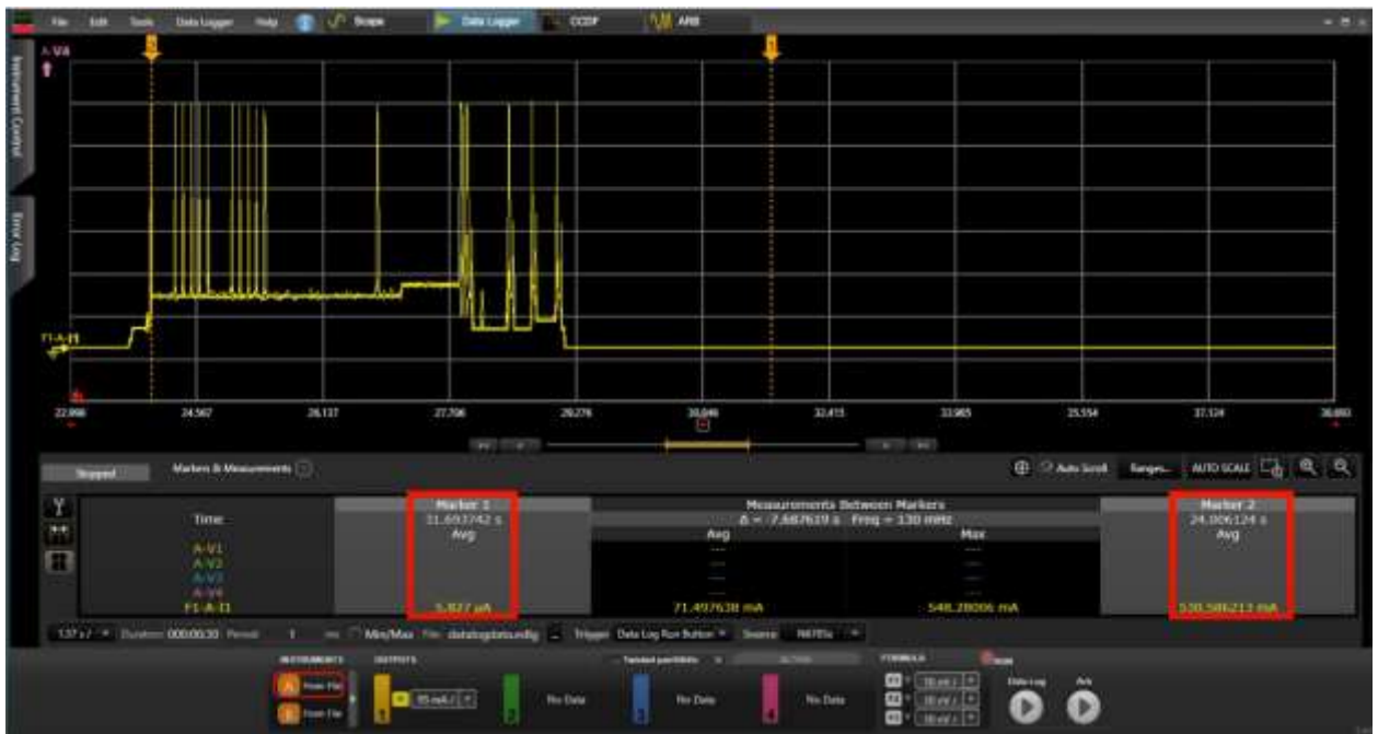
Рисунок 2.13 – Використання осцилографа для вимірювання споживаного струму.
