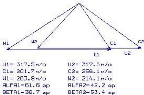
Рисунок 1.11 – Трикутник швидкостей для 6-го ступеня компресора
