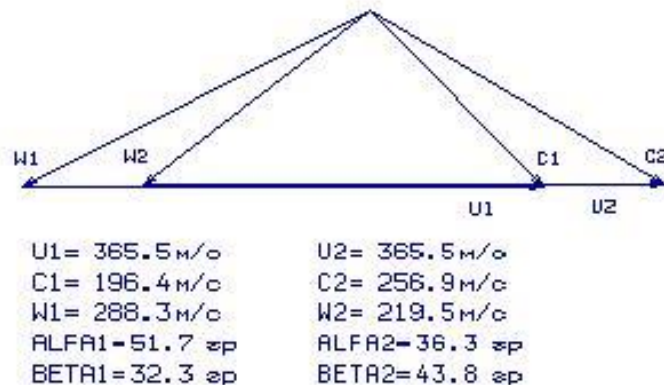
Рисунок 1.18 – Трикутник швидкостей для 13-го ступеня компресора
