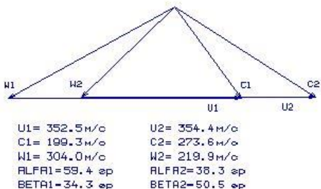
Рисунок 1.13 – Трикутник швидкостей для 8-го ступеня компресора
