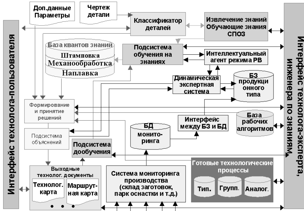
Рис. 1. Архитектура ИСППР «КВАНТ» для технологической подготовки авиационного производства
