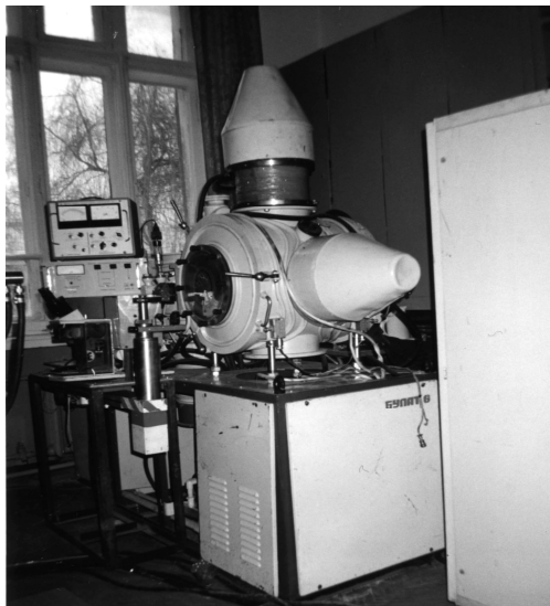
Рис. 1. Лабораторна модульна установка, що трансформується, для нанесення покриттів та комбінованого зміцнення деталей та ріжучого інструменту
