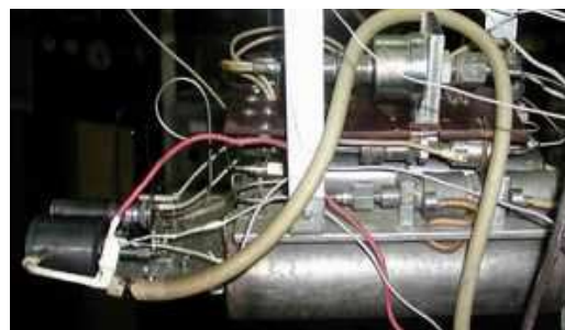
Рис. 12. СХПРТ на стенде с двигателем и катодом-компенсатором
