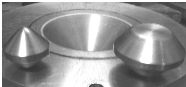
Рис. 7. Вставки, примененные для формообразования конических деталей: справа – на начальном этапе; слева – на промежуточном этапе
