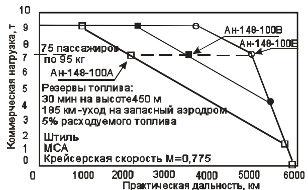
Рис. 1. Семейство модификаций самолета Ан-148, разрабатываемых на основе модульного метода: Ан-148-100А, Ан-148-100В, Ан-148Е
