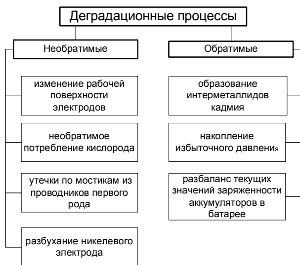
Рис. 4. Деградационные процессы в аккумуляторах
