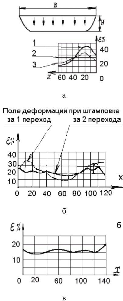
Рис. 4. Выравнивание поля деформаций специальными приемами: а – за счет использования технологических окон 1-3; б – за счет увеличения числа переходов; в – за счет использования подкладки
