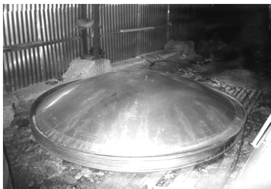
Рис. 2. Изготовленные параболические антенны диаметром 2,5 метра
