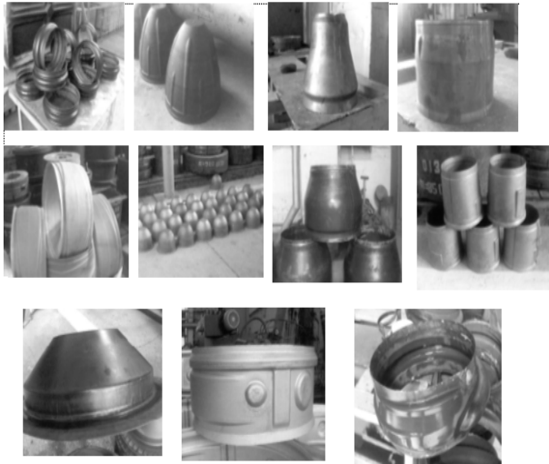
Рис. 2.. Детали, изготовленные методом штамповки взрывом
