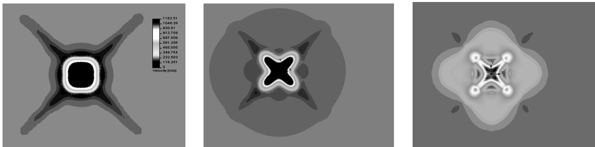
Рис. 11. Поле скоростей в сечениях между головной частью и ТТУ
