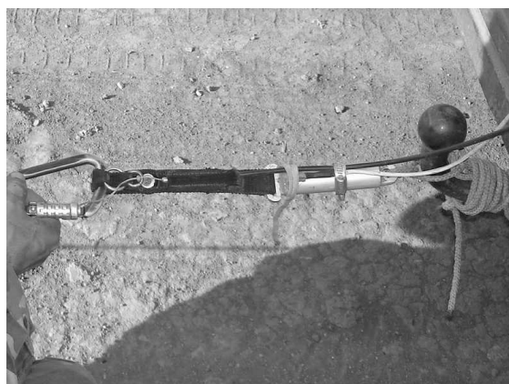
Рис. 8. Тензодатчик буксировочной системы устанавливается на автомобиль
