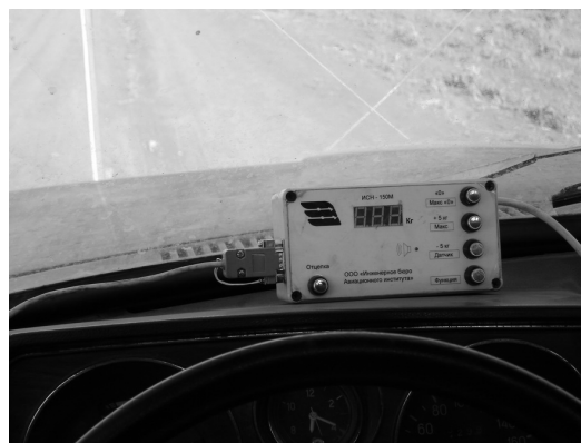
Рис. 9. Электронный блок буксировочной системы устанавливается на автомобиль
