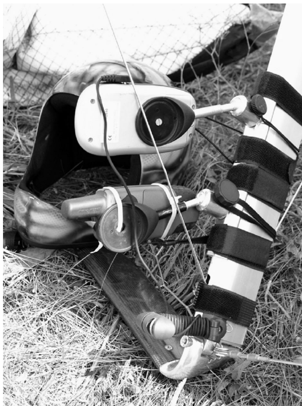
Рис. 7. Установка комбинированного прибора и GPS к стойке трапеции без использования вариобокса
