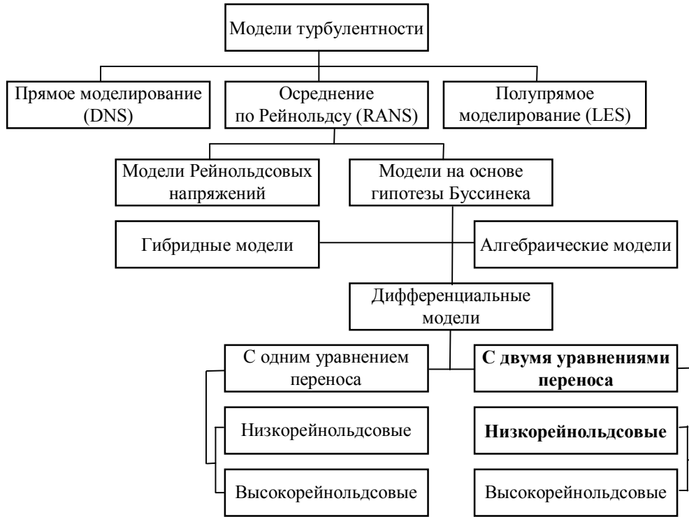
Рис. 1. Иерархия типов моделей турбулентности
