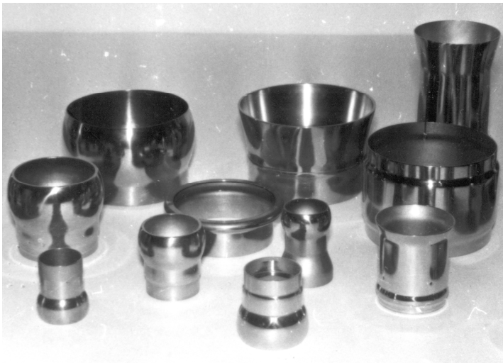
Рис. 2. Типовые осесимметричные детали трубопроводов воздушных систем ЛА
