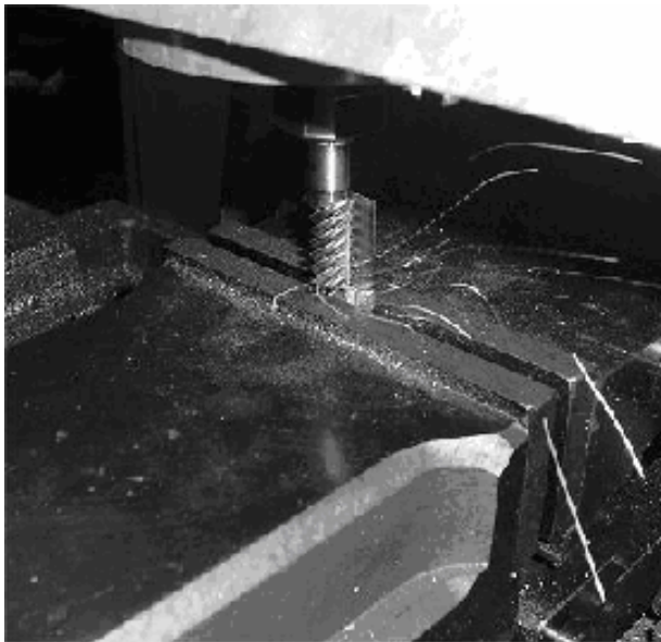
Рис. 4. Процесс обработки руля управления аэродинамической модели
