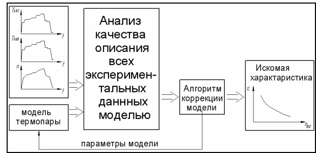
Рис. 1. Общая схема идентификации показаний термопары
