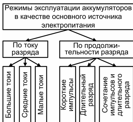
Рис. 2. Режимы эксплуатации аккумуляторов в качестве основного источника электропитания
