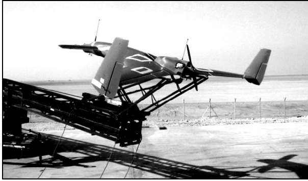
Рис. 2. Свободно летающая динамически подобная модель БЛА Y-R на стартовой пневматической катапульте (изделие Y-H)
