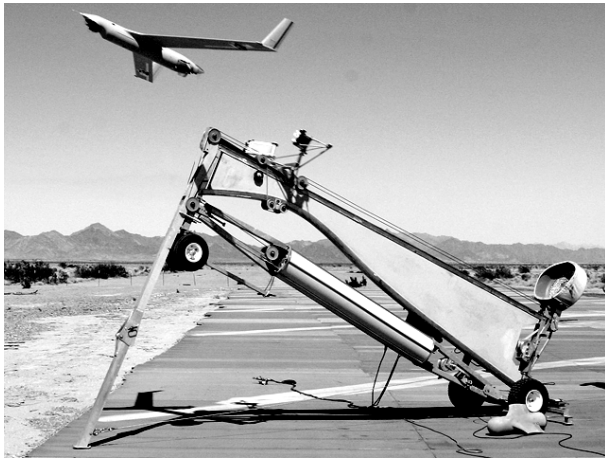
Рис. 1 Пневматическая катапульта фирмы Boeing с вариатором копириного типа для запуска БЛА ScanEagle
