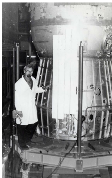
Рис. 10. Профессор Г.А. Горбенко возле радиаторов-излучателей Летной экспериментальной установки ЛЭУ-1М, установленной на корабле «Прогресс»
