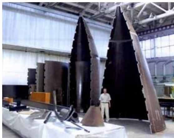
Рис. 15. Элементы конструкций ракетно-космической техники из композиционных материалов
