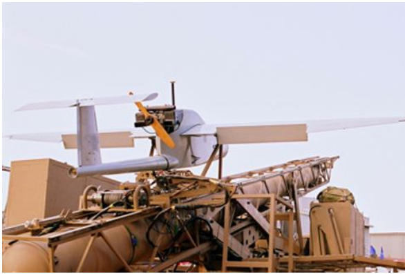
Рис. 1. Работоспособный образец вакуумного НПУ с установленным БЛА «Vulture»
