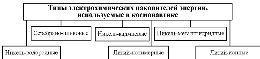
Рис. 2. Типы электрохимических накопителей энергии, используемые в космонавтике
