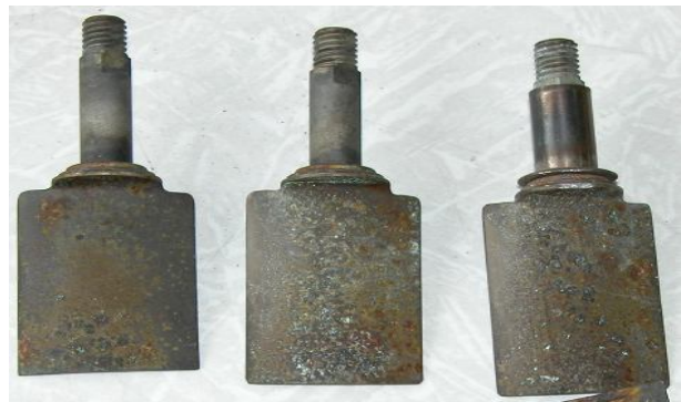
Рис. 2. Корозійне пошкодження сталевих направляючих лопаток 11 та 12 ступеней компресора двигуна Ал-21Ф-3
