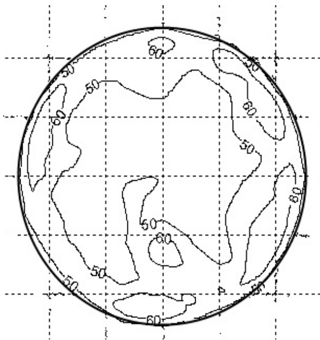
Рис. 4. Типовое поле давлений при использовании профилированного прижимного кольца
