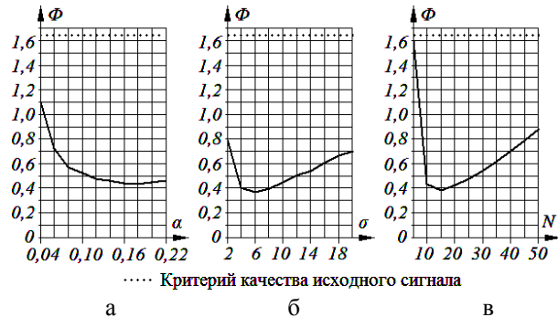
Рис. 9. Критерии качества сигналов для: а – экспоненциального сглаживания, б – метода взвешенного скользящего среднего, в – метода простого скользящего среднего
