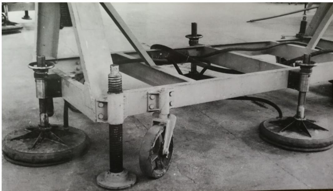
*Устройство на ВП для стыковки СЧК с фюзеляжем*
