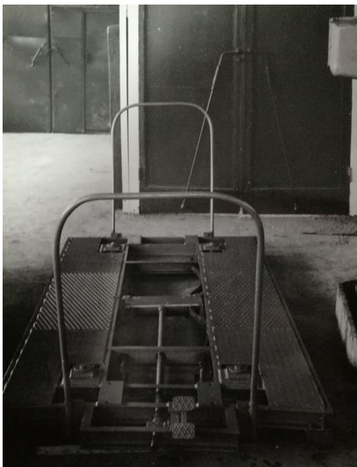
*Платформа на ВП для двигателей тяжелых тракторов*
