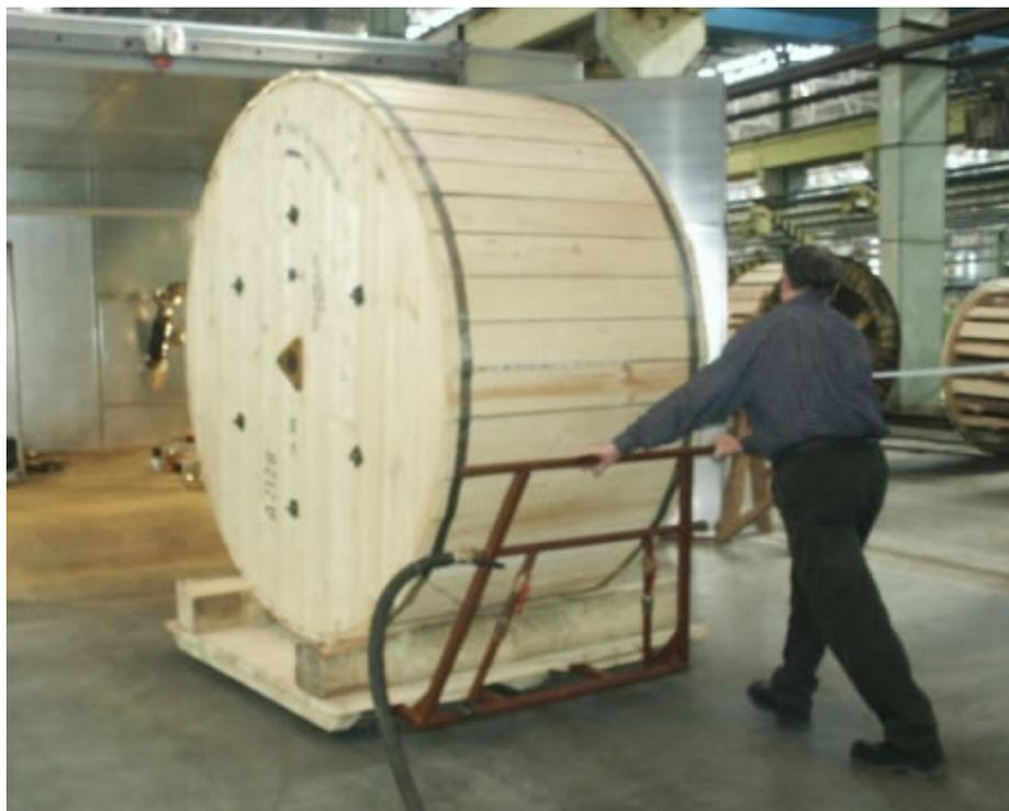
*Заведение барабана с кабелем в испытательную камеру*
