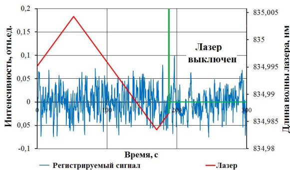
Рис. 5. ЛИФ сигнал \text{Xe}^+ на расстоянии 9,0 мм от среза двигателя при направлении лазера под углом в 30^\circ к оси двигателя
