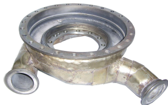
Рис. 2. Двухзаходный спиральный входник осевой турбины с безлопаточным сопловым аппаратом дизеля ЗТД-3
