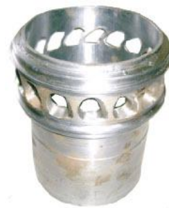
Рис. 3. Прямоугольные впускные окна с наклоном боковых стенок 0...42°
