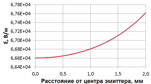
Рис. 11. Распределение E по поверхности эмиттера при расстоянии h = 7 мм
