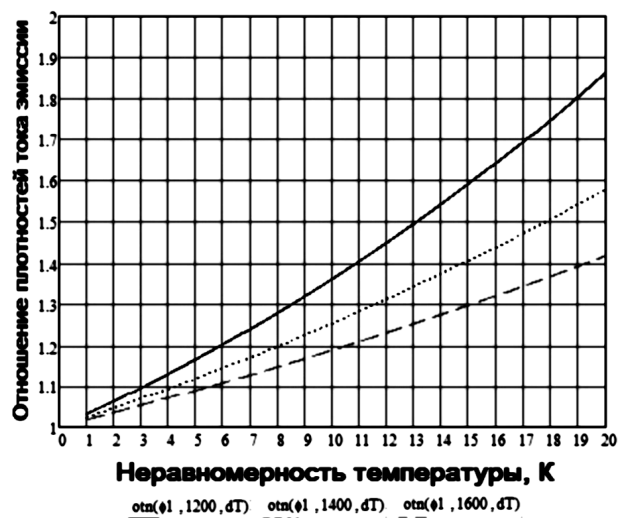
Рис. 5. Зависимости разности плотности тока эмиссии от температурной неравномерности поверхности
