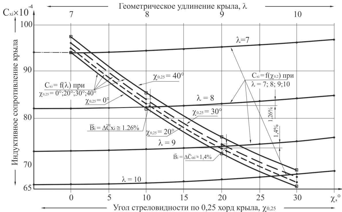
Рис. 3. Зависимость коэффициента индуктивного сопротивления от углов стреловидности и удлинения крыла с \eta = 3,5; C_y = 0,45; S_{кр} - \text{const}
