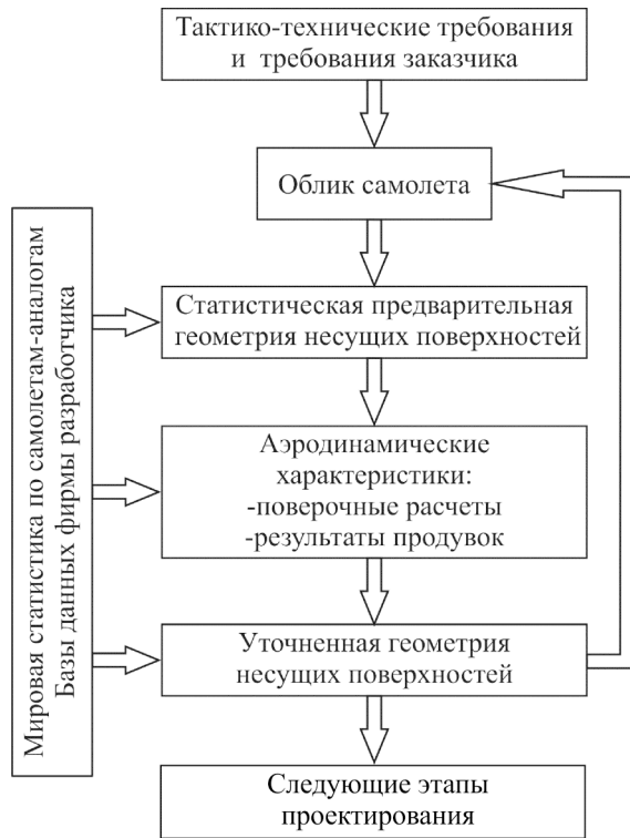
Рис. 1. Схема метода формирования геометрических параметров несущих поверхностей самолета транспортной категории по частным критериям и интегральным показателям его эффективности [4]
