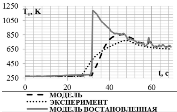
Рис. 9. Сравнение смоделированного и реального запусков ( T_T = f(t) )
